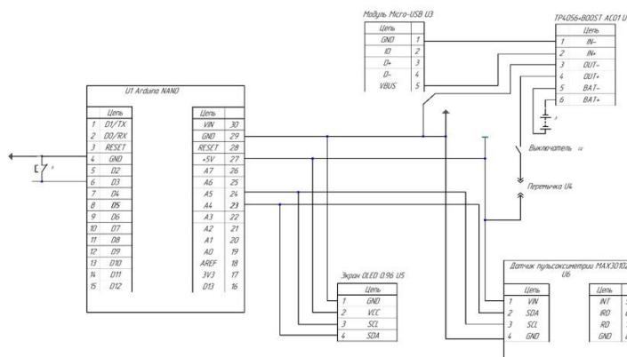
Рис 1. Принципиальная электрическая схема устройства.
