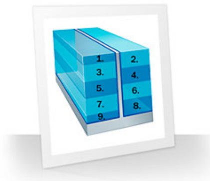
Рис. 12. Снятие припуска послойно в шахматном порядке
