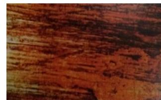
Рис.2 Сервовитная пленка на рабочей поверхности стойки шасси самолета
