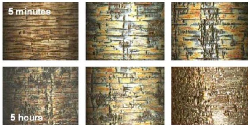
*Рис.5.* Виды износа покрытий. Показывает износ поверхности после 5 минут и 5 часов работы ИМ
