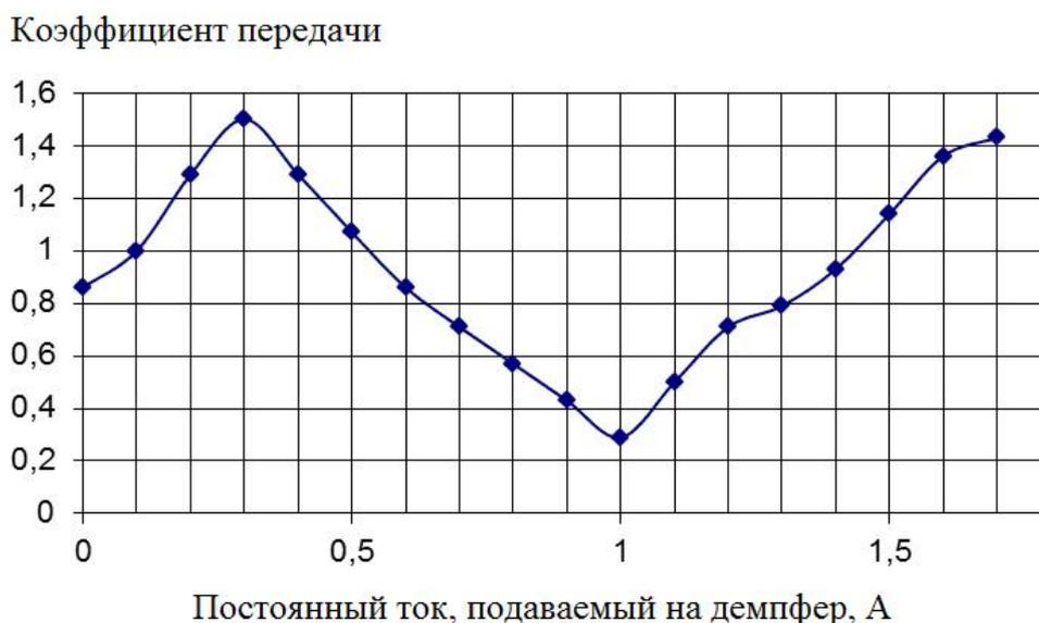
Рис. 3. График зависимости коэффициента передачи амплитуды колебаний демпфера на основе МР – эластомера
