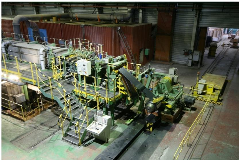
Рис. 7. Линия обезжиривания
