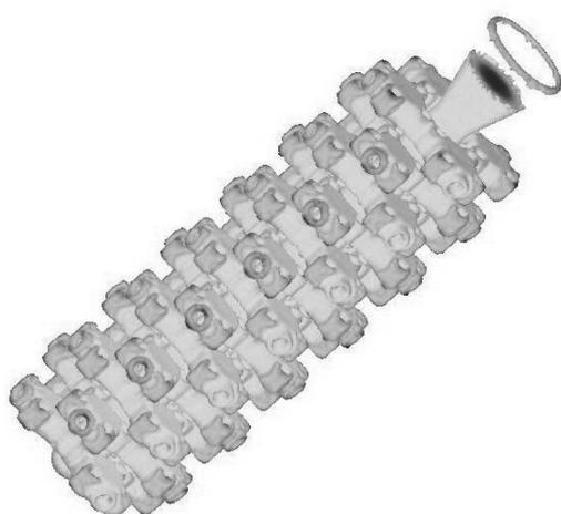
Рис. 12. Распределение температур по объему модельного блока в конце заливки
