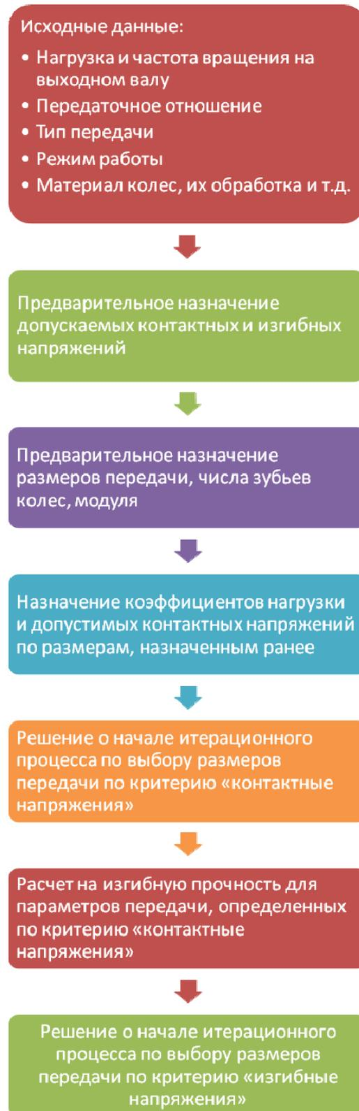
Рис. 1. Общая схема традиционного проектного расчета
