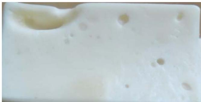
Рис. 5. Неравномерность распределения и размеров включений воздуха
