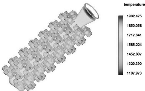
Рис. 2. Распределение температуры в конце заливки
