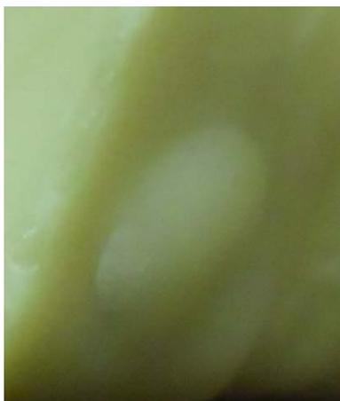
Рис. 1. Пузырек воздуха на поверхности модели
