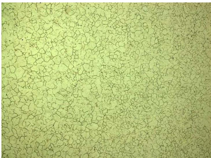
Рис. 6. Микроструктура стали ВКС-180ИЛ после цикла закалок:
