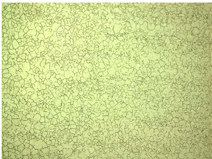
Рис. 7. Микроструктура стали ВКС-180ИЛ после цикла закалок:
