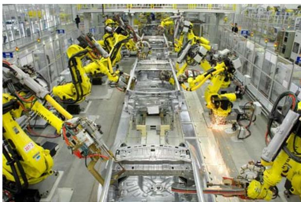
Рис. 1. Сварка на конвейере Hyundai Solyaris
