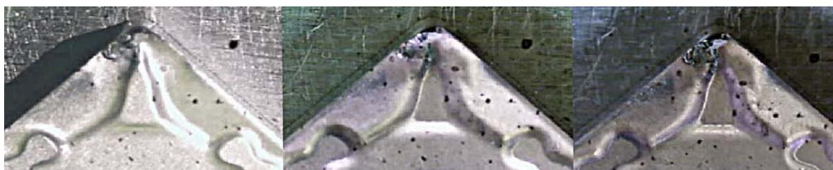
Рис. 3. Фотографии передней кромки  $VK6+(Ti;Si;Al)N$ , слева направо: 135 м, 289 м 436 м
