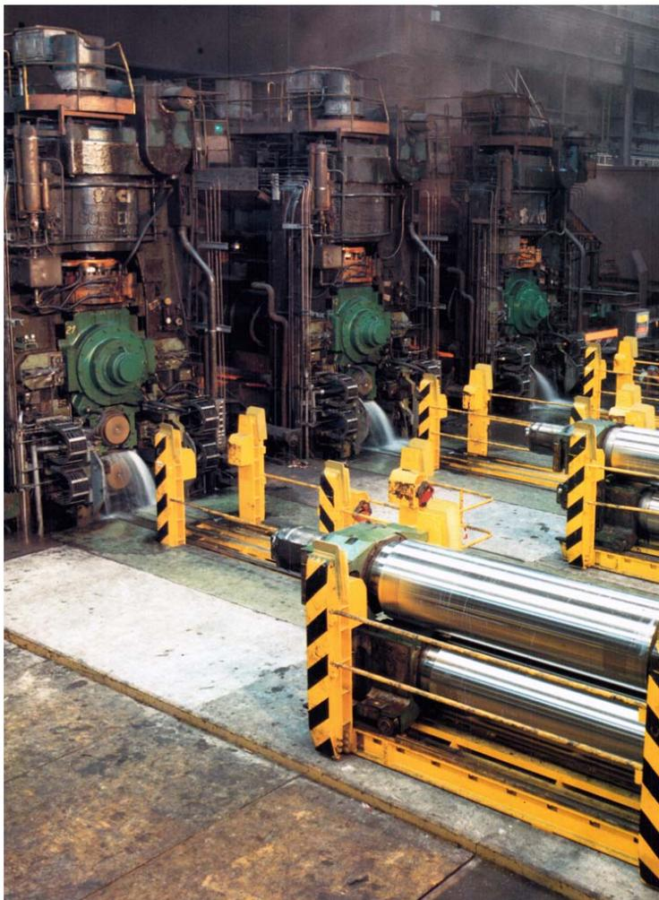
Рис. 10. Четырехвалковые клетки чистового прокатного стана
