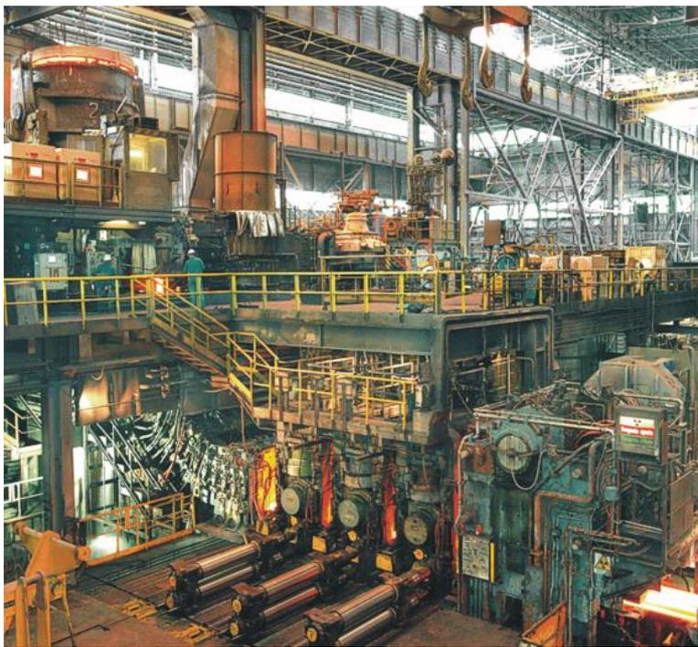
Рис. 5. Машина непрерывного литья агрегата
