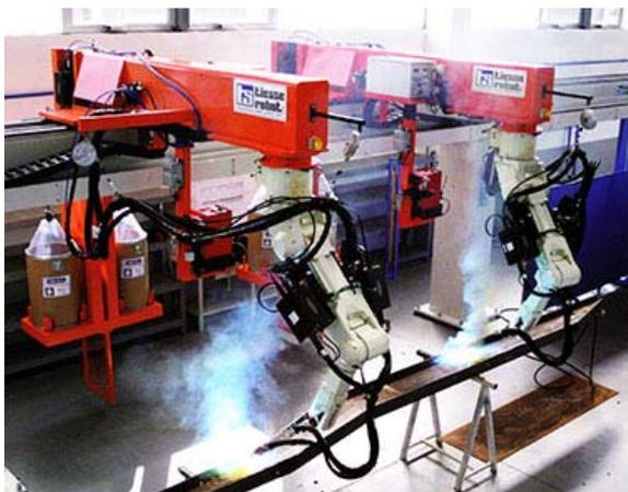
Рис. 3. Применение роботов в дуговой сварке
