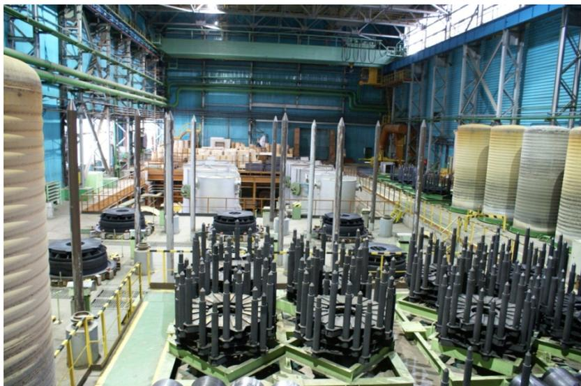
Рис. 5. Колпаковые печи для отжига плотномотанных рулонов
