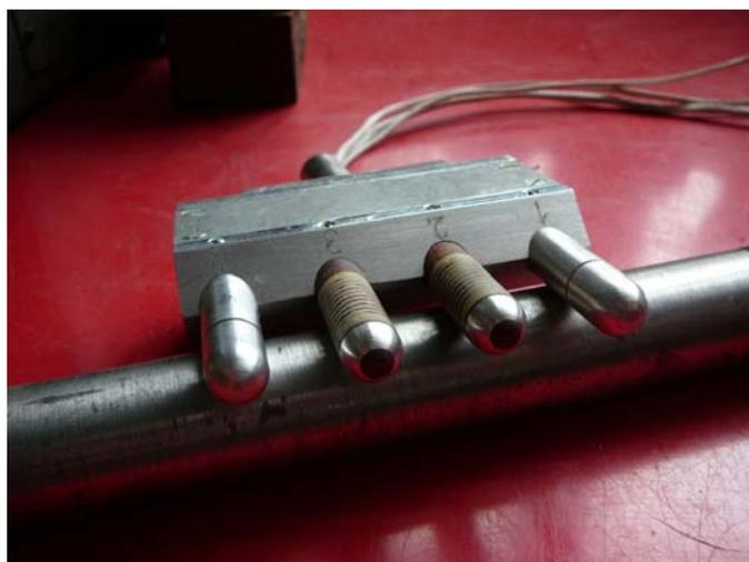
Рис. 5. Устройство для измерения параметров торможения в импульсных гиперзвуковых потоках
