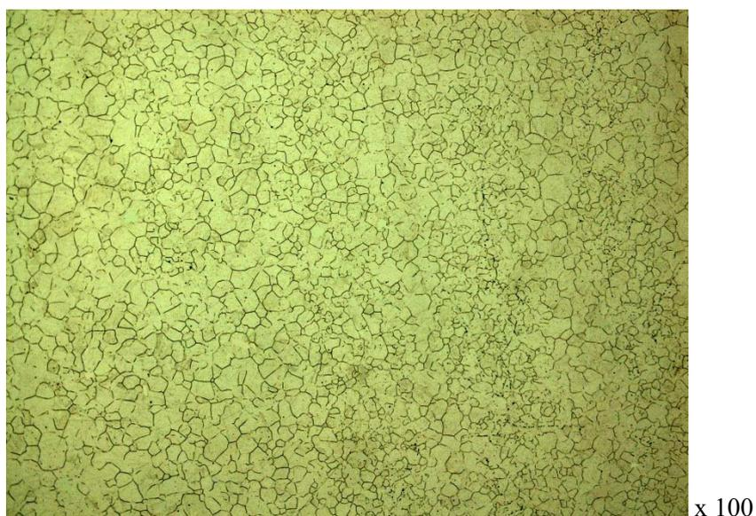
Рис. 5. Микроструктура стали ВКС-180ИЛ после цикла закалок:
